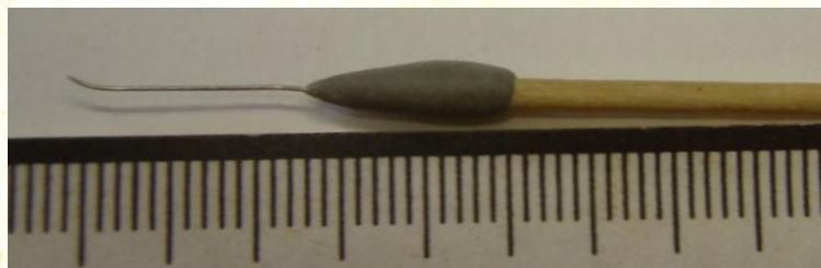
Стек из контровочной проволоки диаметром 0,3мм
