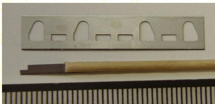
Режущие инструменты. Верхнее лезвие извлечено из кассеты для бритвенного станка и в таком-же виде используется. Нижнее из того-же станка, но обрезано. Обрезанная заготовка будущего инструмента вклеена в рукоятку из зубочистки.
