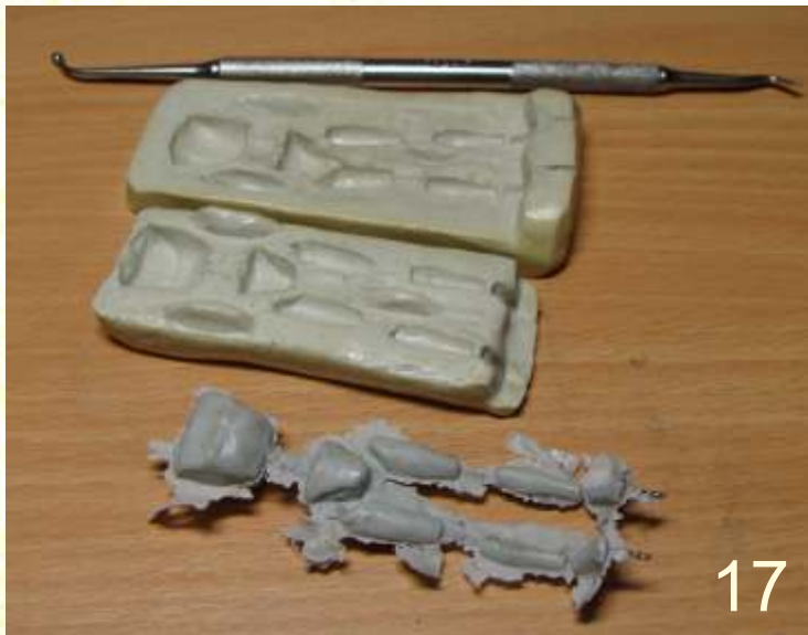
18. Удаляем штамповочный облой.
